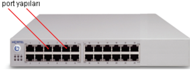
Şekil 76. 24 portlu bir switch
