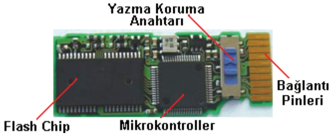
Şekil 102. Hafıza kartı içyapısı ve bileşenleri
