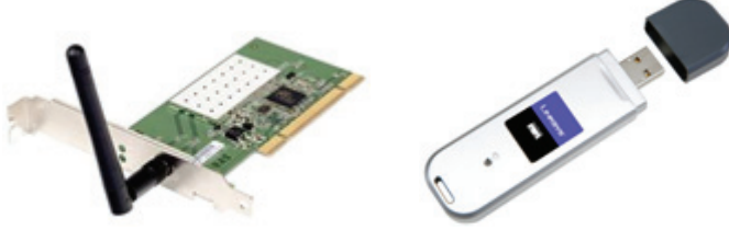
Şekil 74. Kablosuz ağ kartı ve aynı işi gören USB adaptör
