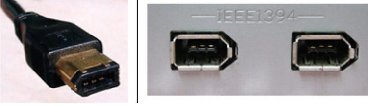
Şekil 12. IEEE1394 Firewire kablo ve port konektörleri
