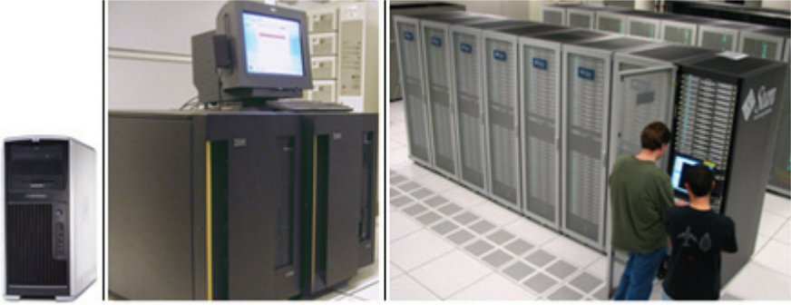
Şekil 4. Soldan sağa sırayla iş istasyonu, mainframe ve süper bilgisayar
