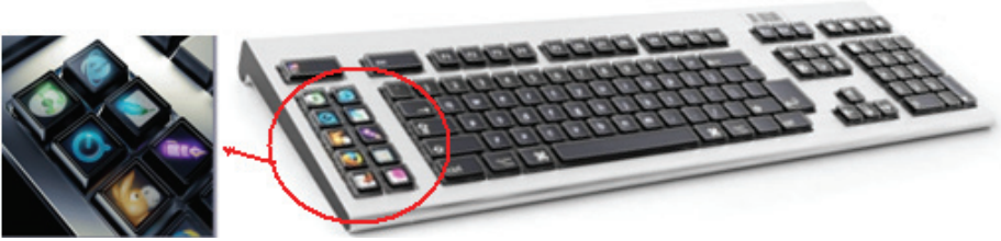
Şekil 80. Sağda Optimus klavye ve solda tuşların yakından görünüşü(www.artlebedev.com)
