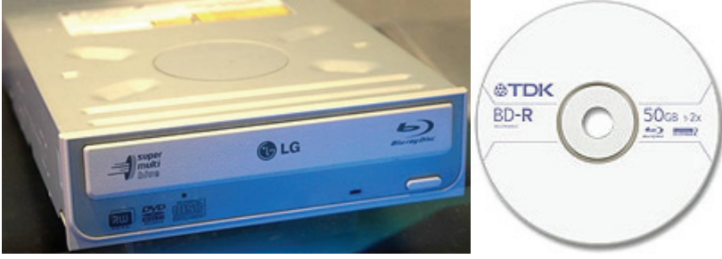
Şekil 67. Solda CD, DVD ve Blu-Ray yazıcı/okuyucu. Sağda Blu-Ray disk.
