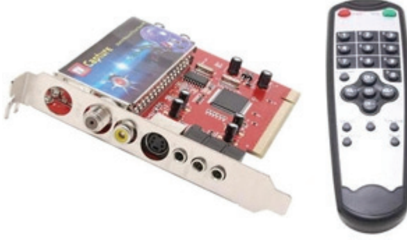
Şekil 119. Televizyon kartı ve uzaktan kumandası
