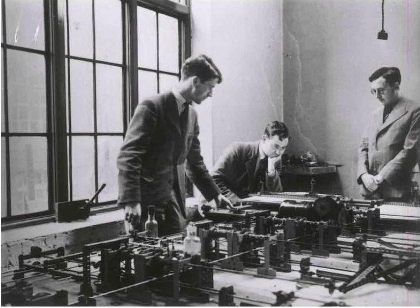
Şekil 8.2: Diferansiyel denklem çözümü için kullanılan bir analog bilgisayar, 1937 Cambridge Üniversitesi Matematik Laboratuvarı.
