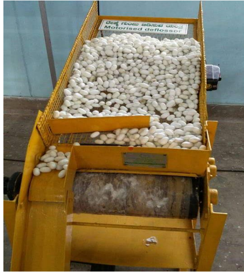
Şəkil 78. Barama təmizləyən qurğu
