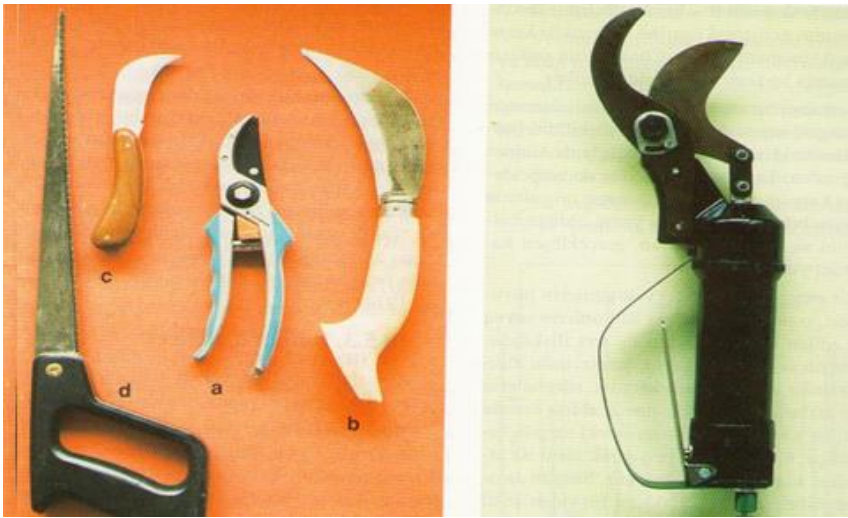
Şəkil 47. Tənəyin budanmasında istifadə olunan alətlər
