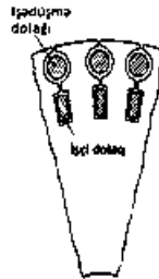
Şəkil 6.23. İki ədəd qısa qapanmış dolaqlı rotor.
