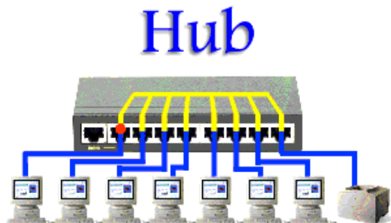
Şəkil 2.12. Hub-a kompüterlərin qoşulma sxemi 9 .
